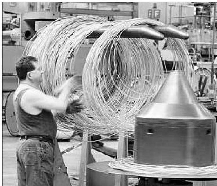
Ein Mitarbeiter der Swissmetal in Dornach mit frisch gepresstem Draht aus Kupferlegierung. (Ky)
