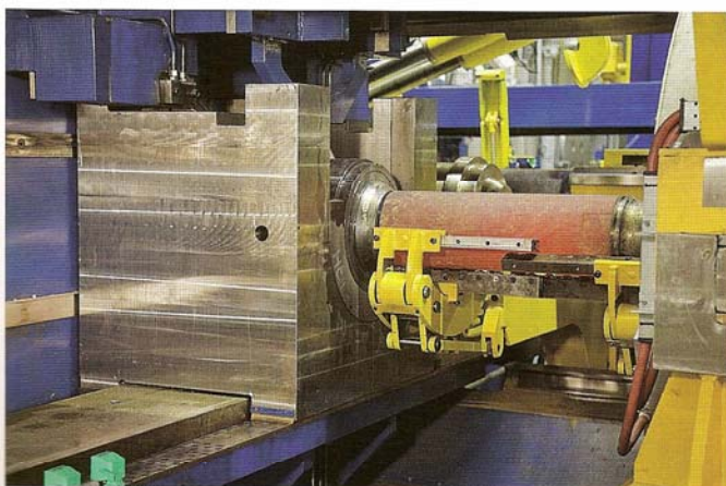
Vorgewärmter Bolzen beim Beladen der Presse (Foto: SMS)
