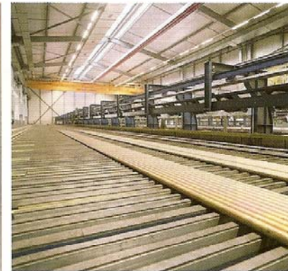
Auslauf der Strangpresse (Foto: SMS)
